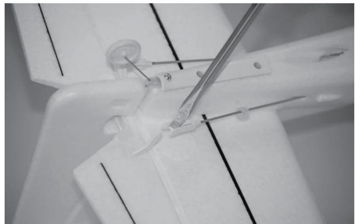
Nach dem Anschließen der Gabelköpfe an die Steuerhörner sehen Sie den Seitenleitwerk und das Seitenruder von oben. Das Seitenruder sollte in einer Linie mit dem Seitenleitwerk sein, wenn es richtig „zentriert“ ist. Wenn das Seitenruder jedoch nach rechts oder links abgewinkelt ist, können Sie die Länge/Position der Schubstange/Gabel so einstellen, dass die Oberfläche „mechanisch“ zentriert wird, während der Trimmhebel am Sender zentriert ist.
